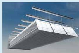
最終沈殿池の流出部に傾斜板を多数配置して、汚泥フロックを速やかに沈降させることで、最終沈殿池の沈殿分離効率を高めます。
