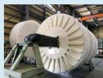
円板体に固着させた微生物膜を利用して排水を浄化します。空気中では酸素を吸収、汚水中では汚濁成分を吸着して好機的に分解。容易な管理で長期に亘り安定した水処理性能を発揮します。
