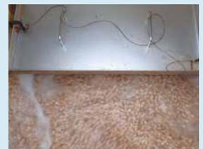
耐久性の高いポリオレフィン素材の微生物固定化担体を槽内に内蔵し、高濃度で排水処理を行います。
